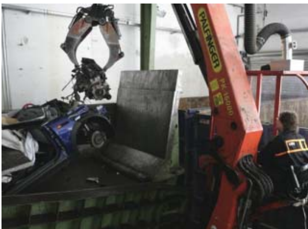
Abb. 7: Separation von Restkarosse und Motorgetriebeblock
