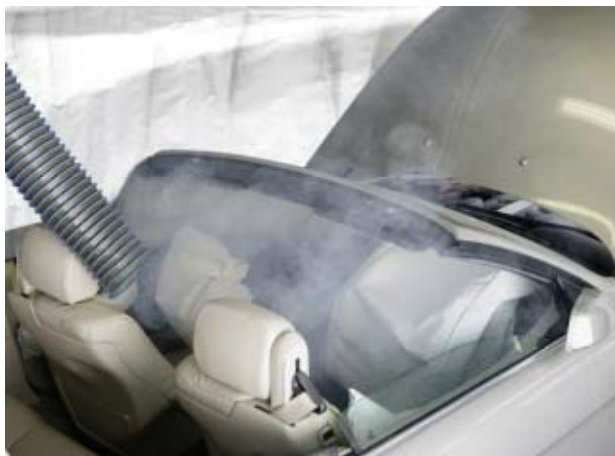
Abb. 3 und 4: Neutralisation der Pyrotechnischen Einheiten
